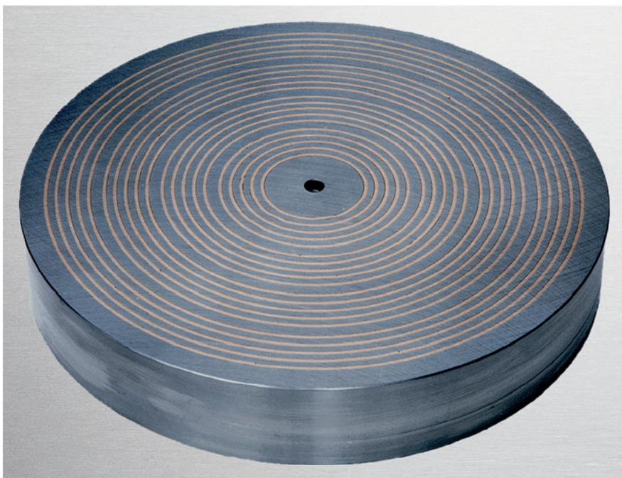
**Elektro-Permanent-Magnet-Spannfutter Type 1230 mit Ringpolteilung** eignen sich besonders zum exzentrischen Aufspannen von Massenteilen oder auch zum Spannen von dünnen Werkstücken, wie zum Beispiel Sägeblätter und Kreismesser.
